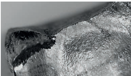
Nadmierne obciążenie płytki prowadzi do jej pęknięcia.
