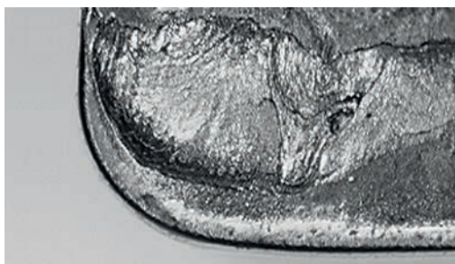
Usuwany wiór z miejsca skrawania powoduje powstawanie kraterów.
