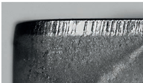
Zużycie ściernie na krawędzi narzędzia, normalne zużycie po określonym czasie obróbki.
